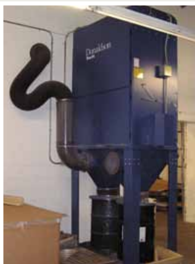
UMA 450 filtering plastic from a CNC machine
